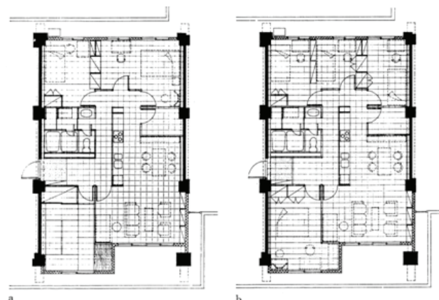
図 1-2 KEP-I 試作住宅の平面図 (左：供給段階，右：間取り変更の例)
