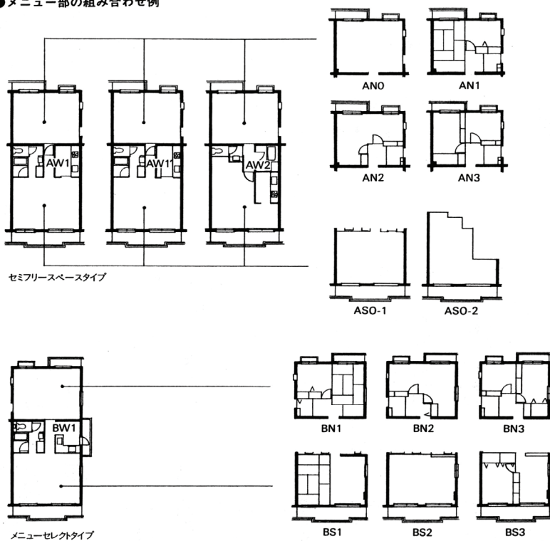
図 2-13 光が丘パークタウンの躯体平面図とメニュープラン
